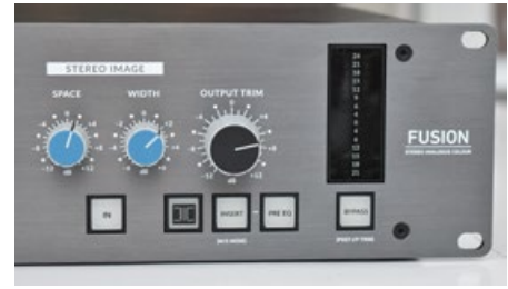
STEREO IMAGE verbreitert das Signal, für mehr "Mojo" lässt sich ein Übertrager aktivieren.
