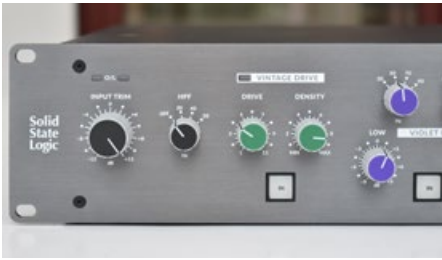
Nach Eingangsstufe und einstellbaren High Pass Filter lässt sich das Signal dank der analogen VINTAGE DRIVE Schaltung mit Obertönen anreichern
